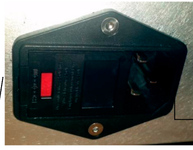
Locatie van systeemzekeringen
